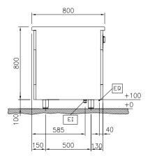
Electrical inlet (power) EQ Equipotential screw
